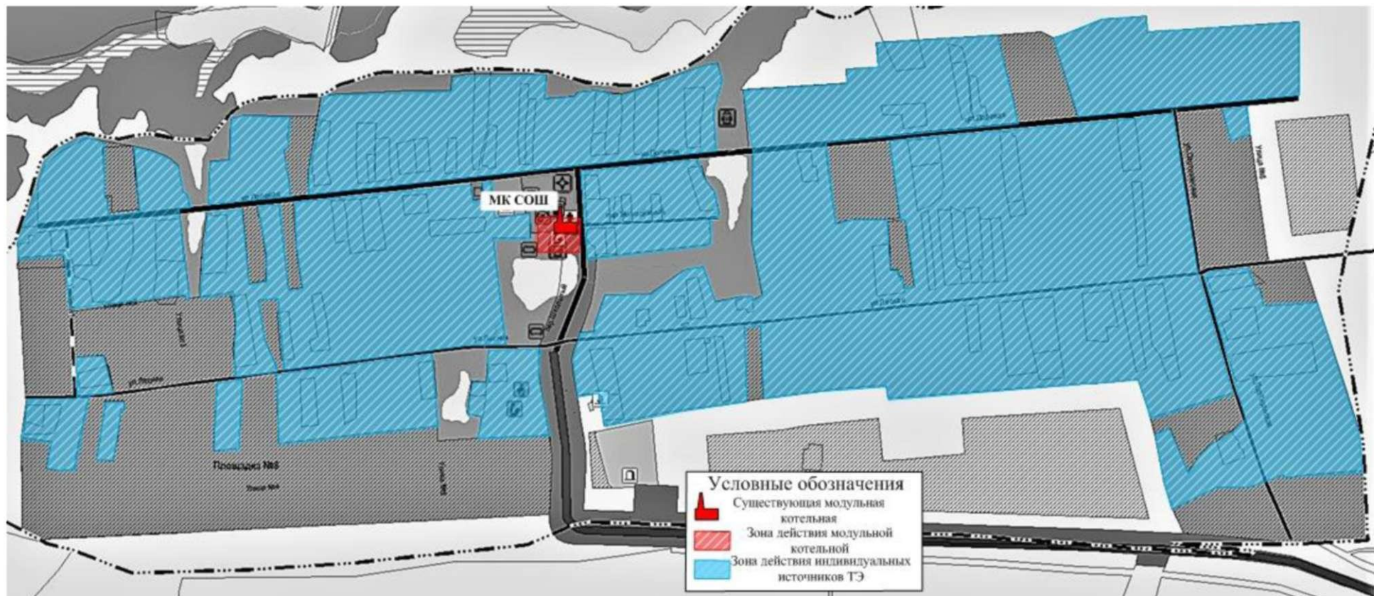
Рис. № 7 - Зоны действия модульной котельной и индивидуальных источников тепловой энергии на территории села Успенка
